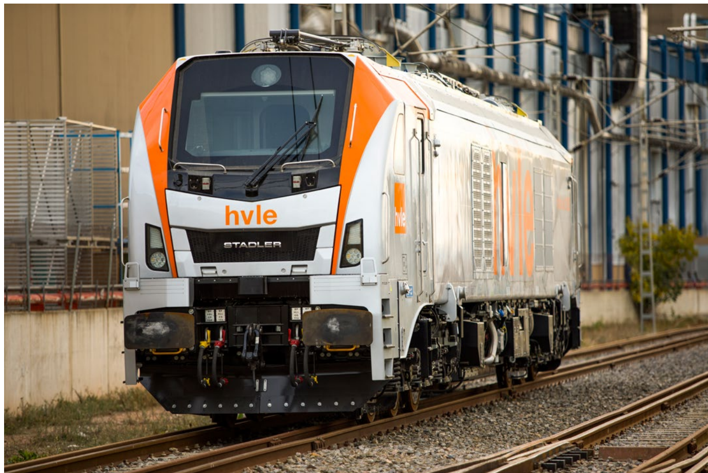
Abb. 4: Lokomotive Eurodual – Zugkraft bis zu 500 kN
